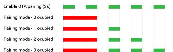
ペアリングモードが有効な場合、現在設定されているスロットIDをステータスLEDが緑色に点滅して表示します。
