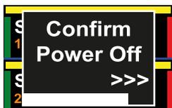
デバイスの電源オフは、オン/オフスイッチを押しながら **ボタン4** を押し、常に必ず確認する必要があります。ユーザーが電源オフを確認しない場合、デバイスはシャットダウンされません。
